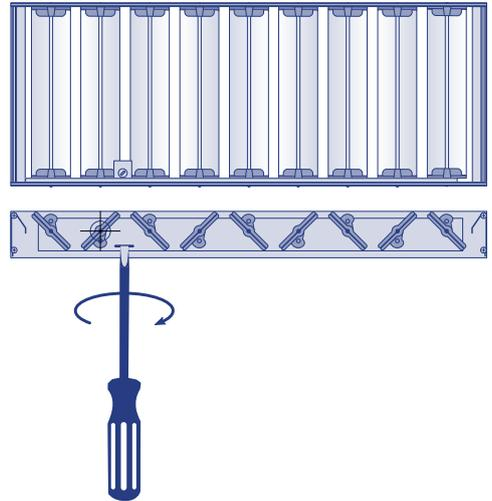
1. Tournez le vis avec un dévissage jusqu'à obtenir l'ouverture souhaitée.
