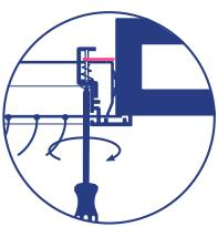
4.1 À l'aide d'un tournevis, vissez la languette pour la placer horizontalement.
