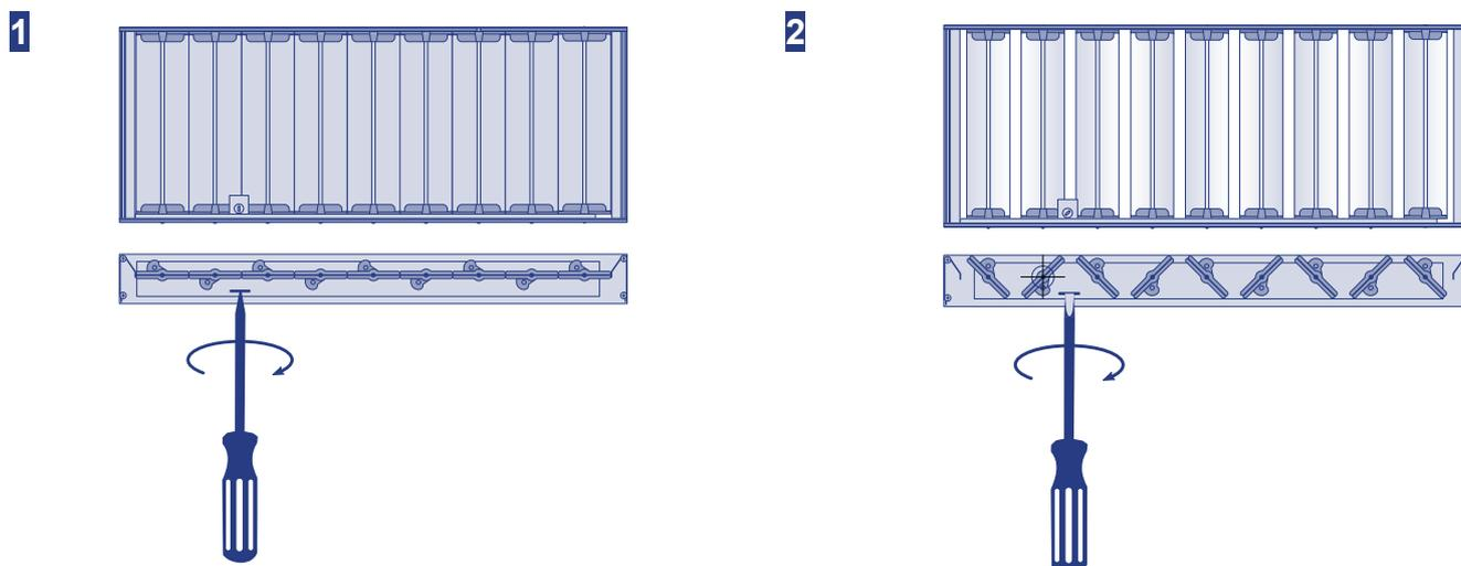
1. Tournez le vis avec un dévissageur jusqu'à obtenir l'ouverture souhaitée.
