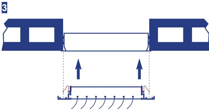
3. Placez la grille avec ressorts à l'intérieur du contre cadre. Appuyez d'abord sur un côté puis sur l'autre.
