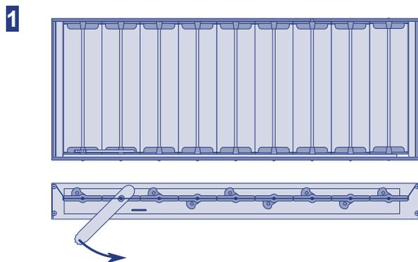
1. Le réglage du registre se réalise avec le levier qui dépasse légèrement de la partie frontale de la grille.
