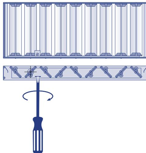
1. Tournez le vis avec un dévissage jusqu'à obtenir l'ouverture souhaitée.
