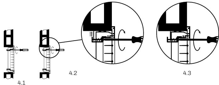
4.1 À l'aide d'un tournevis, vissez la languette pour la placer horizontalement.
