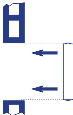
2. Installez le contre cadre (E-MM ou E-MAM). Fixez-la au mur avec du mortier ou du plâtre.
