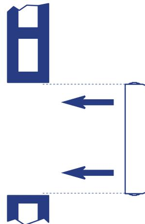
2. Installez le contre cadre (E-MM ou E-MAM). Fixez-le au mur avec du mortier ou du plâtre.
