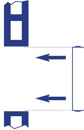
2. Installer le contre cadre (E-MM ou E-MAM). Fixez-le au mur avec du mortier ou du plâtre.
