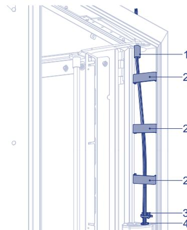
4. Faites passer les câbles par l'ouverture. utilisez le manchon de protection (1), les clips de fixation (2) et le collier serre-câble (3) pour fixer les câbles au cadre. Introduisez les câbles dans la boîte de raccordement par le passe-fil (4) et raccordez selon le schéma de raccordement.
