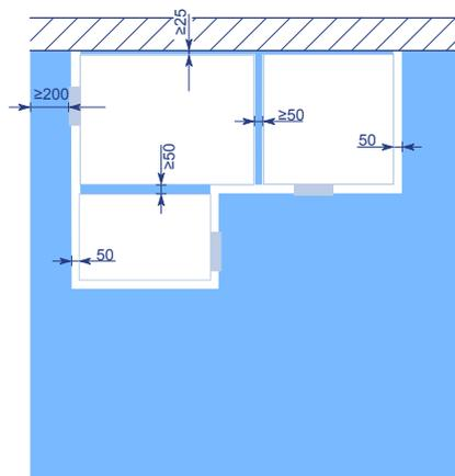
4. Les clapets peuvent être installés à distance minimale d'une dalle/d'un plafond (≥ 25 mm), d'une paroi ou d'un autre clapet (≥ 50 mm).
