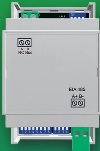
La pasarela de comunicaciones es una pieza clave en el funcionamiento del sistema de zonas. Permite la comunicación con el climatizador.
