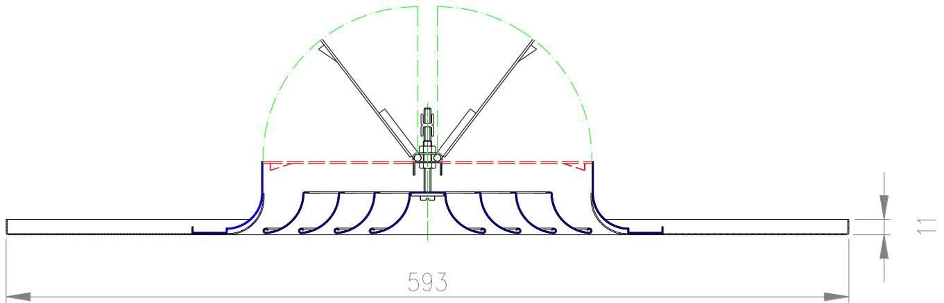
**PLACAMOD:** Cette option est conçue pour les plafonds modulaires. Le diffuseur est intégré sur une dalle en tôle des dimensions standards 593 x 593.
