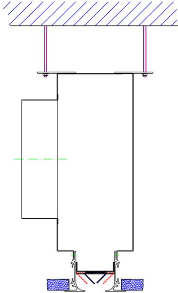
**Plenum:** El difusor E-VIST con plenum siempre se suministra con este remachado al difusor. Todo el conjunto se sujeta mediante varillas roscadas o elementos similares que se fijan a las aletas que el plenum lleva para dicho cometido.
