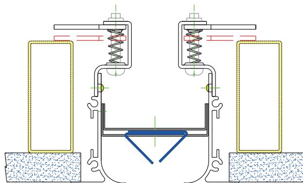
**Pestillos:** Es posible suministrar el difusor E-VIST con pestillos y E-TACO2 para su fijación. Los E-TACO2 se adhieren a la cara interior del techo mediante el adhesivo incorporado. Posteriormente se atornillan los pestillos de manera que la lengüeta de los mismos haga tope con los E-TACO2 fijando así el difusor.
