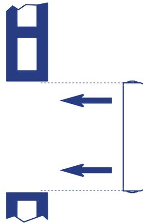
2. Colocar el marco metálico (E-MM o E-MAM). Fijarlo mediante mortero o yeso.
