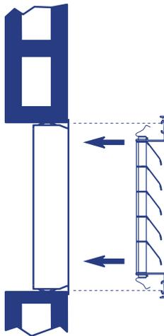
3. Colocar la rejilla con muelles dentro del marco metálico. Presionar primero un lado y luego el otro.
