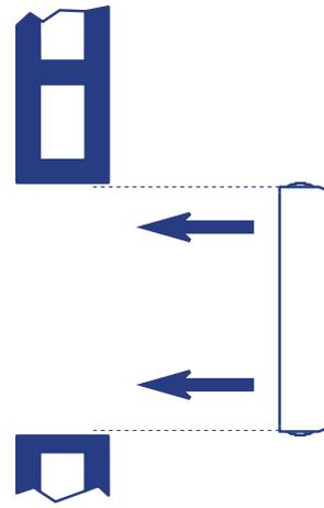
2. Colocar el marco metálico (E-MM o E-MAM). Fijarlo a la pared con mortero o yeso.
