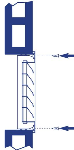
4. Colocar tornillos en los orificios del marco de la rejilla.
