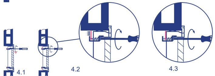
4.1 À l'aide d'un tournevis, vissez la languette pour la placer horizontalement.
