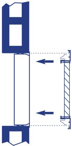
3. Placez la grille avec ressorts à l'intérieur du contre cadre. Appuyez d'abord sur un côté puis sur l'autre.
